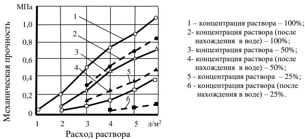
Рис.4. График зависимости механической прочности покрытий, образованных мелассой свекловичной, от её расхода и концентрации
