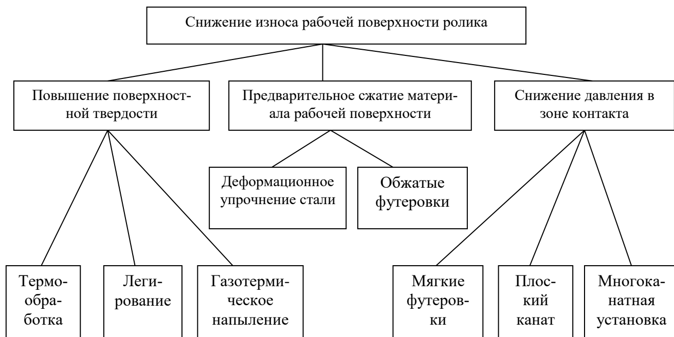
Рис.4. Способы снижения износа рабочей поверхности ролика.
