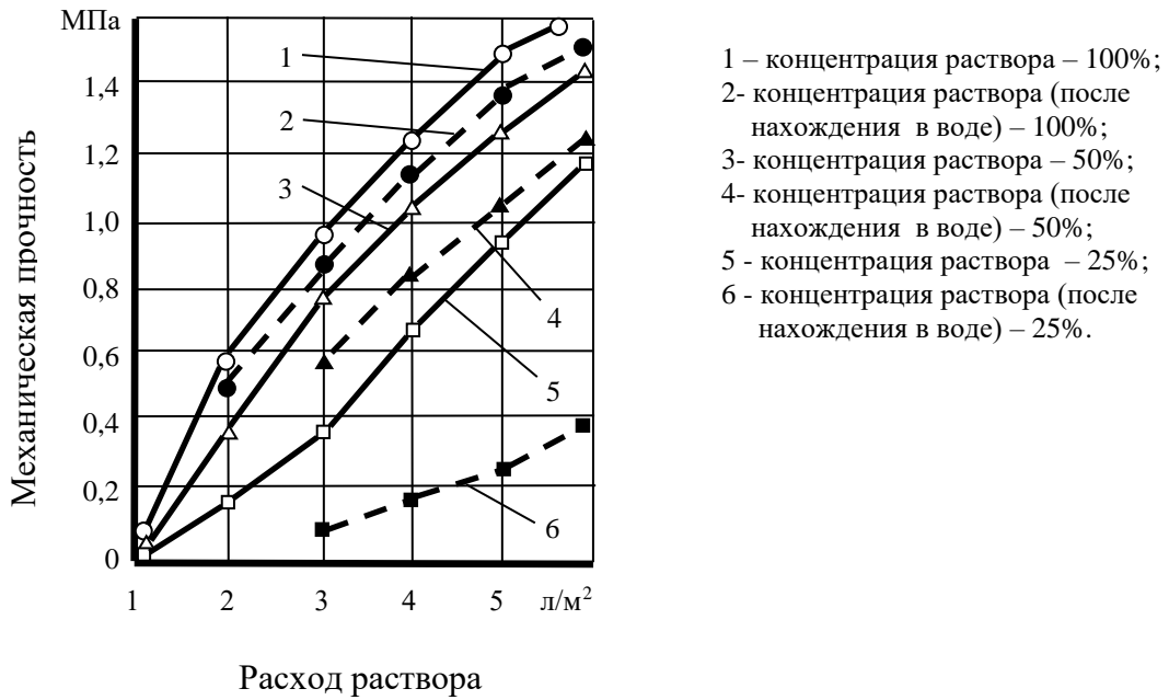
Рис.1. График зависимости механической прочности покрытий, образованных экстрактом кукурузным, от его расхода и концентрации
