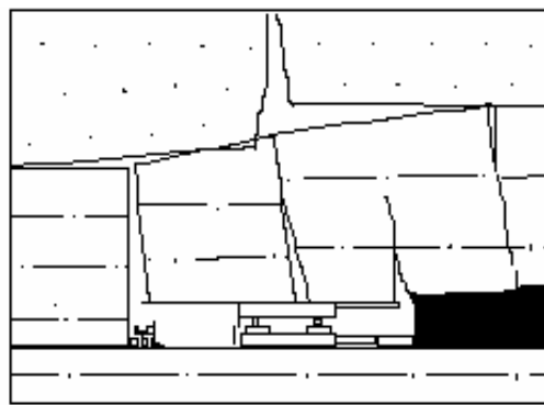
Рис. 2. Обрушения пород кровли крупными блоками
