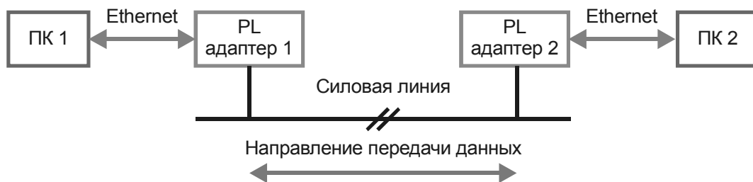
Рис. 2. Информационная схема экспериментального стенда.
