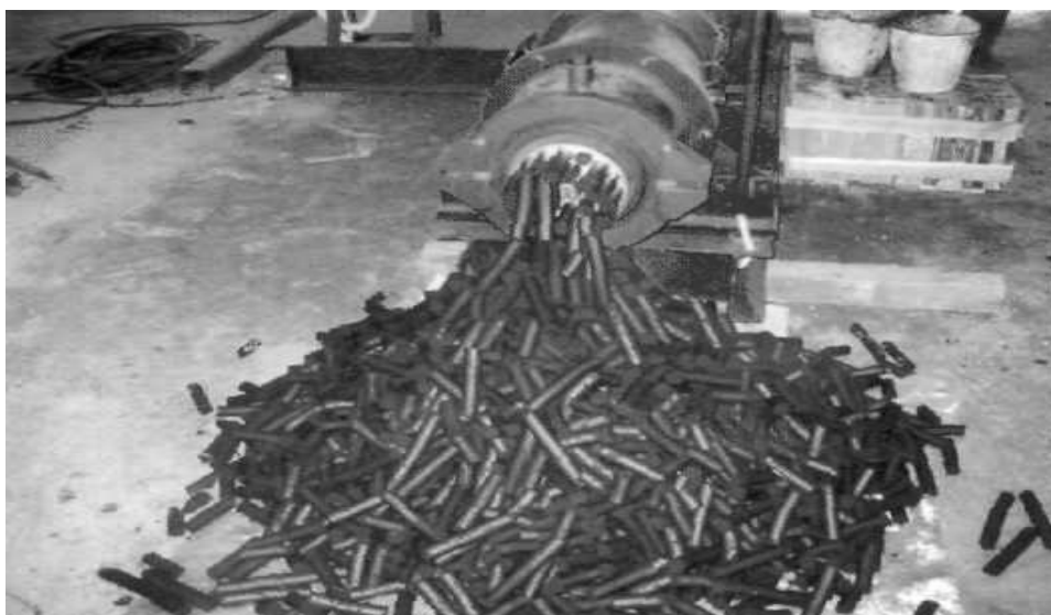
Рис. 2. Готовое окускованное топливо (исходный материал антрацитовый шлам)
