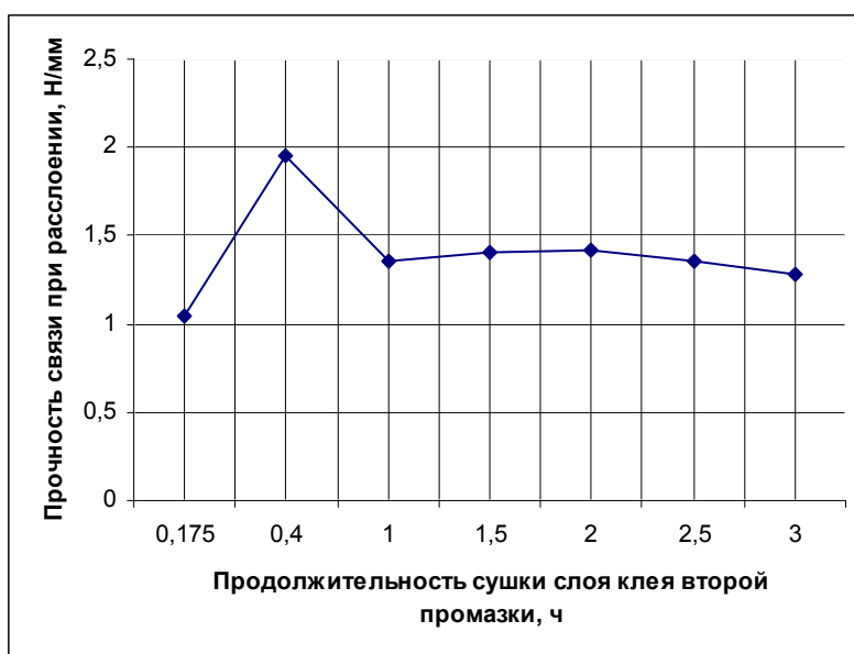
Рис. 1. Зависимость прочности связи соединения от продолжительности сушки слоя клея второй промазки (удельное статическое усилие прижатия 5 \cdot 10^5 Н/м 2 )
