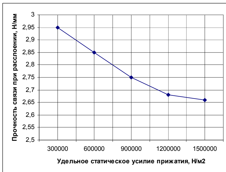
Рис. 3. Изменение прочности связи соединения при различных удельных усилиях прижатия (продолжительность сушки слоя второй клеевой промазки 0,25 ч и выдержки после соединения – 4 ч)
