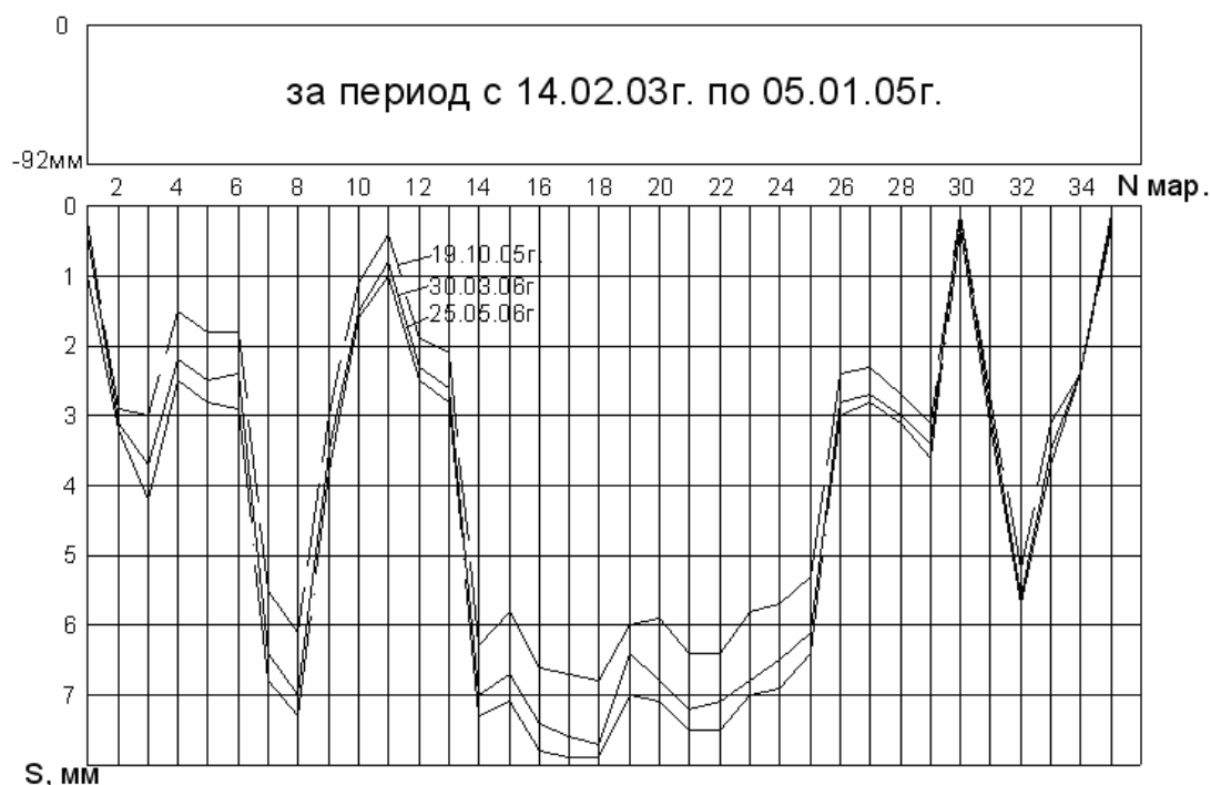
Рис. 2. Графики осадок деформационных марок, начало наблюдений – 21.06.05
