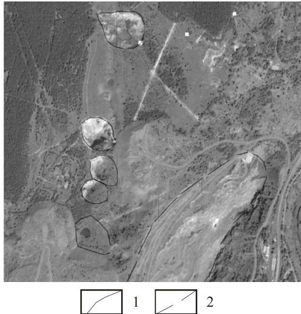
Рис. 3. Поширення провалів в межах гірничого відводу шахти ім. С.М. Кірова: 1 – зони утворення провалів; 2 – діючий кар'єр.
