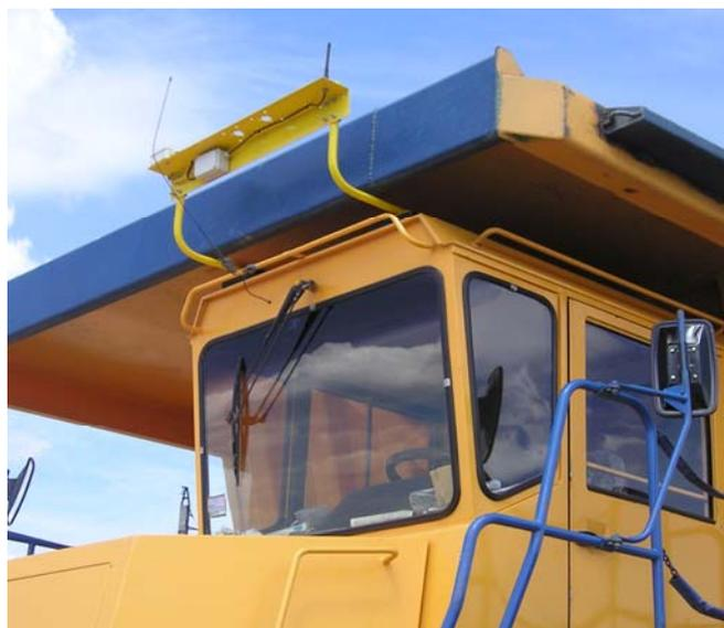
Рис.1. Общий вид навигационного оборудования автосамосвала БелАЗ-7548
