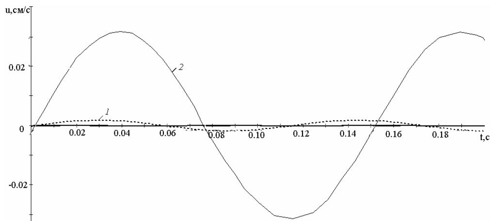
Рис.1. Зависимости горизонтальных перемещений грунтового основания от времени при взрывах на глубине  $h=50 \text{ м}$  и приведенной массе наземного сооружения  $q = 0,0005 \text{ кгс}\cdot\text{с}^2\cdot\text{см}^{-3}$  и разных периодах колебаний: 1 -  $T = 0,11 \text{ с}$ ; 2-  $T = 0,15 \text{ с}$ .
