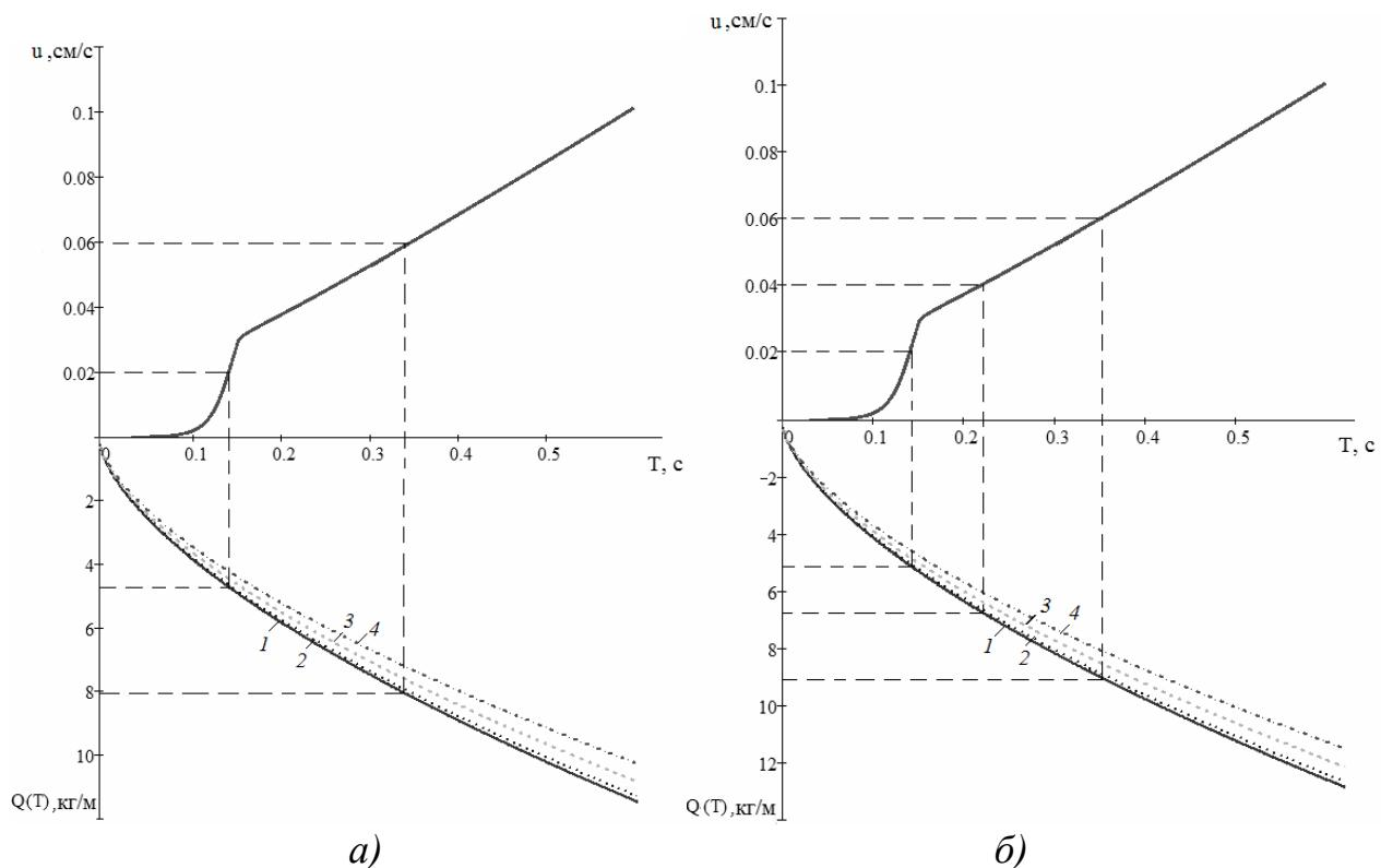
Рис 2. Номограмма определения сейсмобезопасной линейной массы цилиндрического заряда при проведении взрывных работ для известняков (а) и гранитов (б) при длине зарядов: 1-  $l=0,5$  м, 2 -  $l=3$  м, 3 -  $l=10$  м, 4 -  $l=20$  м
