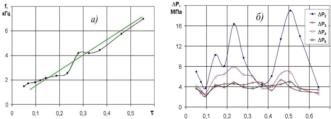
Рис. 6. Экспериментальные зависимости (а) частоты и (б) размаха автоколебаний от параметра кавитации в разных сечениях модели имитатора скважины
