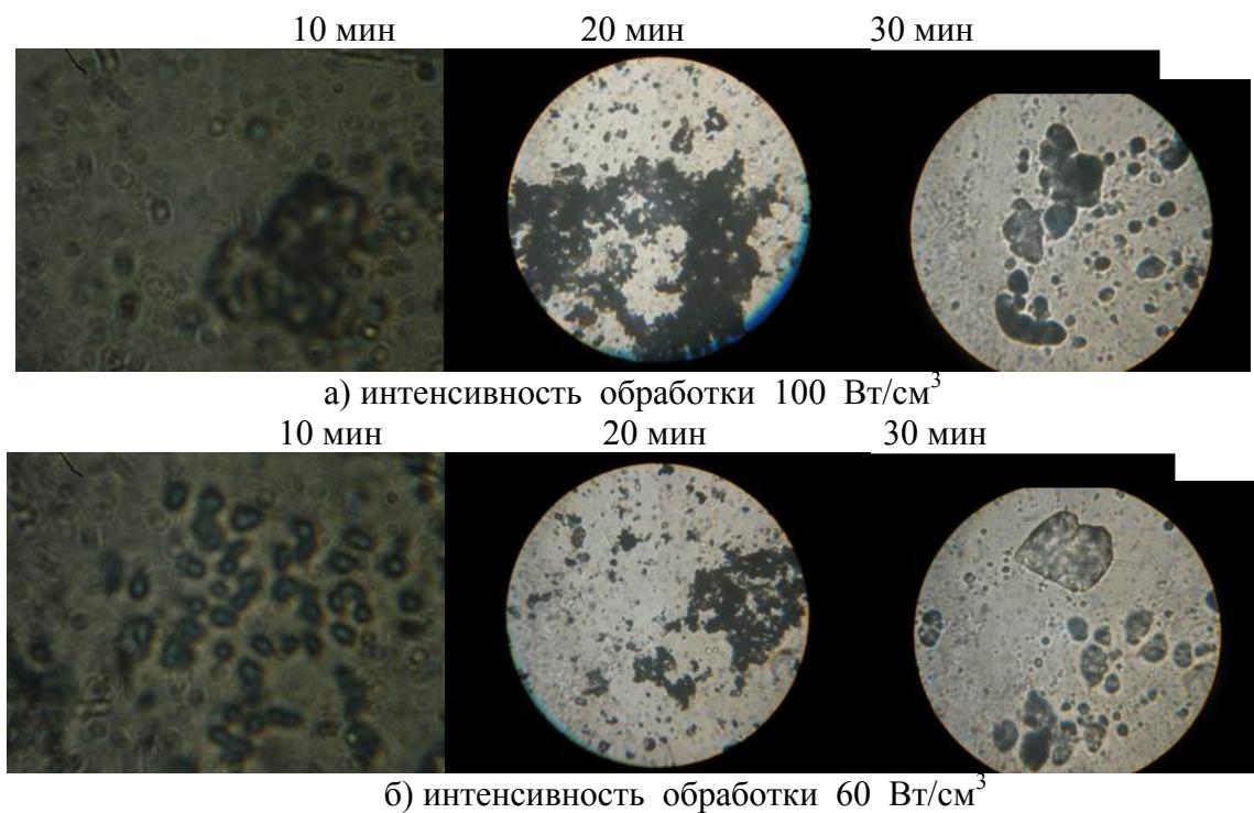
Рис. 4. Микрофотографии осадков, полученных ультразвуковой обработкой сточных вод
