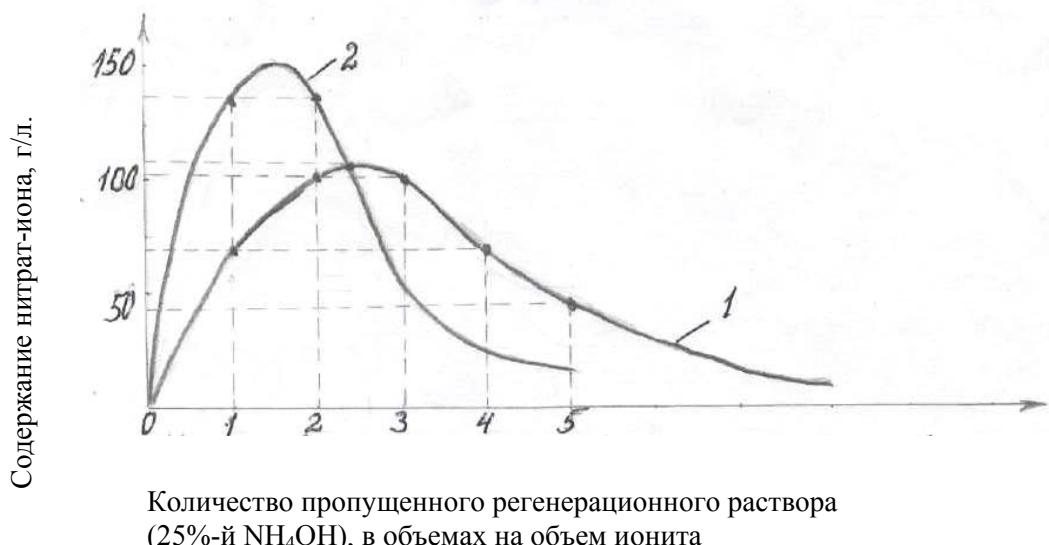
Рис. 2. Выходные кривые регенерации анионита 15%-ной аммиачной водой
