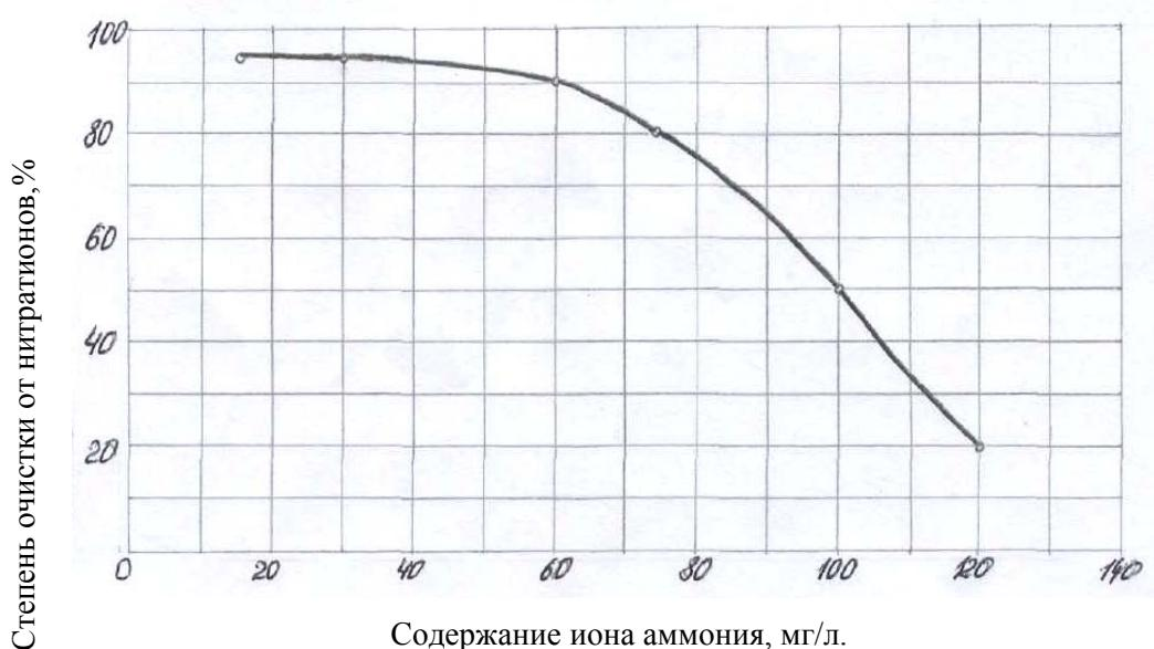
Рис. 1. Изменение степени очистки конденсата от нитрат-иона анионитом АН-22-8 в зависимости от содержания в растворе ионов аммония
