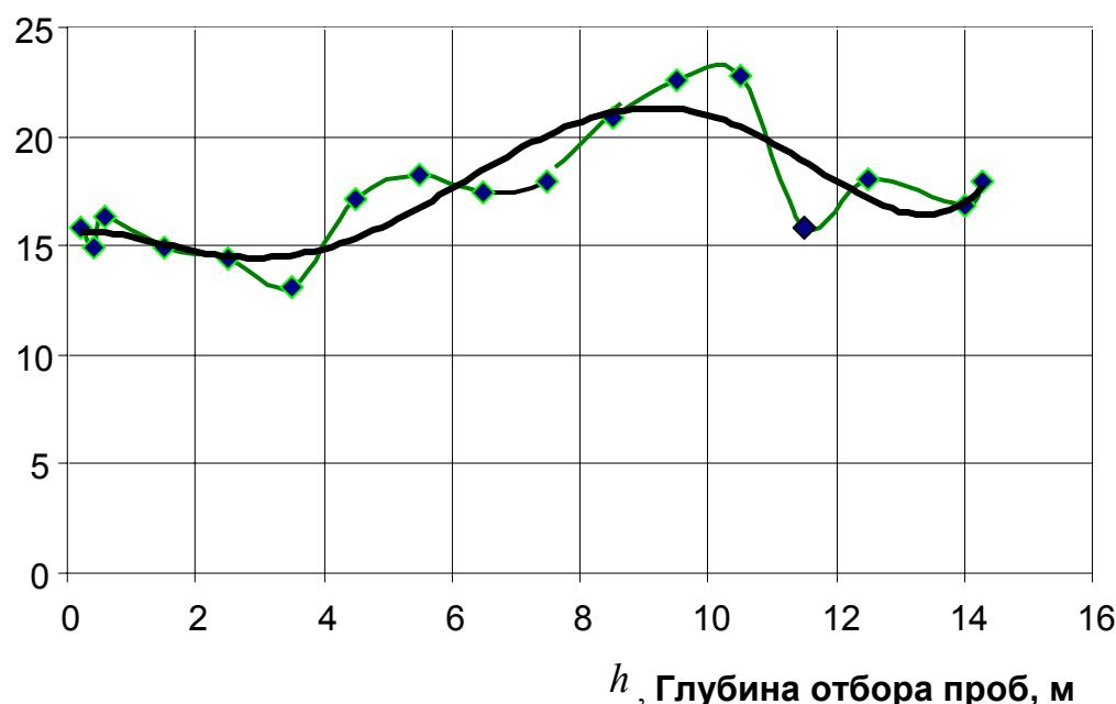
Рис. 1. Зависимость влажности грунта по глубине склада чернозема
