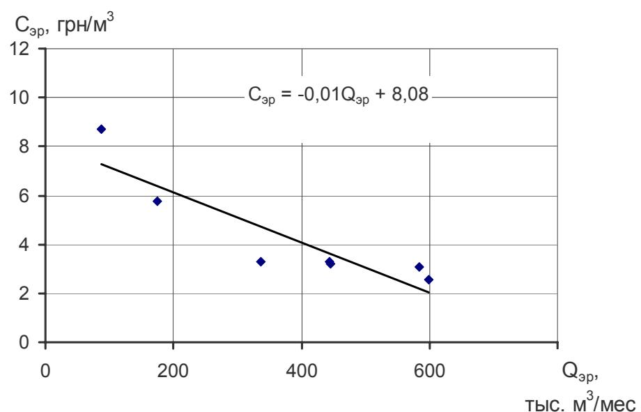
Рис.1. Эмпирическая зависимость себестоимости разработки 1  $\text{м}^3$  вскрыши от производительности роторного комплекса НКМЗ (карьер «ЮГ»)
