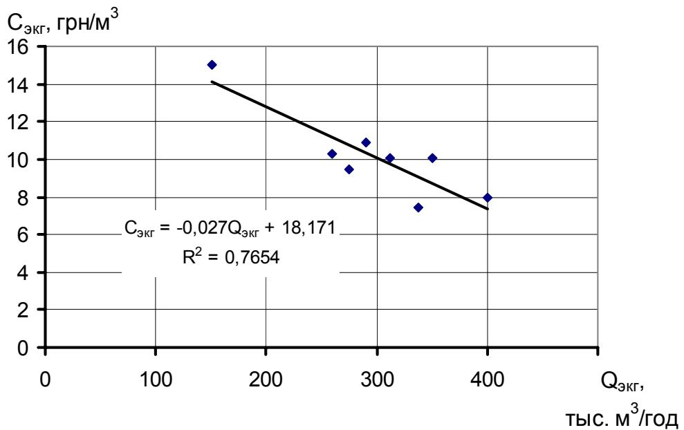
Рис.3. Эмпирическая зависимость себестоимости разработки 1 м<sup>3</sup> вскрыши от производительности вскрышного комплекса ЭКГ+автосамосвалы для карьера № 7 «Север» и «Юг»
