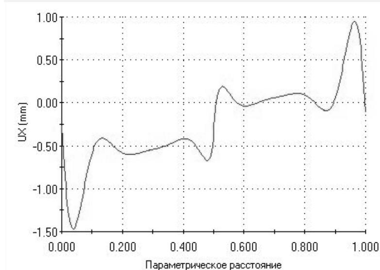
Рис.5. Радиальное перемещение кромки обечайки при контактной модели взаимодействия
