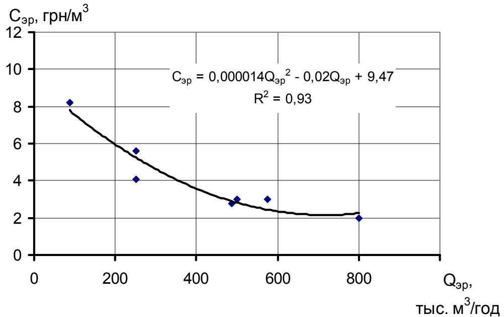
Рис.2. Эмпирическая зависимость себестоимости разработки 1 м<sup>3</sup> вскрыши от производительности роторного комплекса ТК-2 (карьер «Север»)
