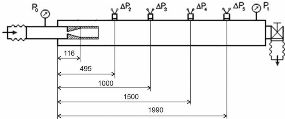
Рис. 5. Схема испытаний УГИВ на модели имитатора скважины
