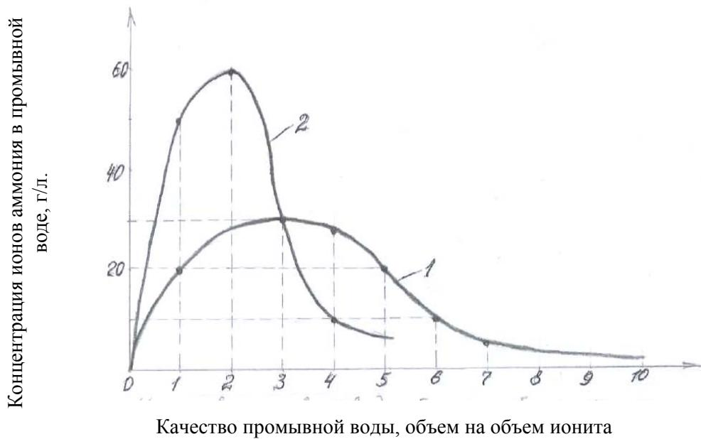
1 – непрерывный режим регенерации; 2 – порционный режим регенерации
