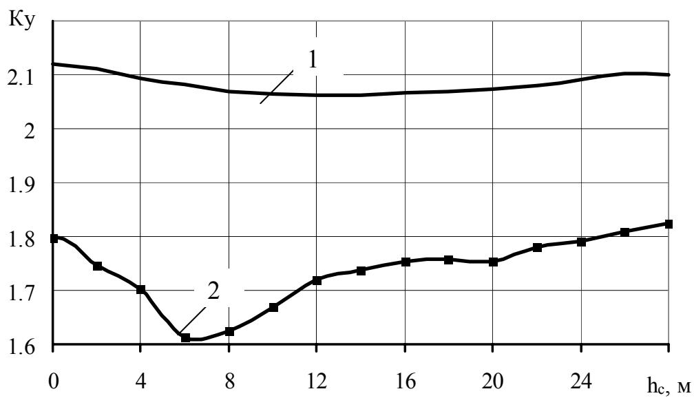
Рис. 3. Графіки зміни коефіцієнта стійкості укосу  $K_y$  при зміні висоти контакту шарів  $h_c$  (м) глинистих порід щодо нижньої бровки уступу в природних умовах і при обводнюванні верхнього шару: 1 – істотний необводнений стан; 2 – обводнений верхній шар
