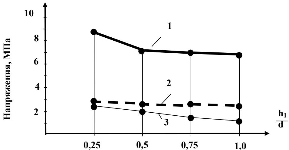
Рис. 9. Зависимость значений максимальных напряжений в резиновой матрице РТК под армирующими тросами от толщины слоя резины под тросом
