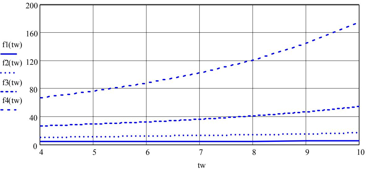
Рис.1. Зависимость размера ТР от температуры охлаждающей воды
