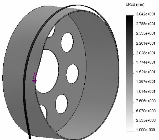
Рис.3. Перемещения обечайки и каната
