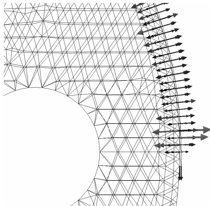
Рис.4. Векторное представление контактных напряжений
