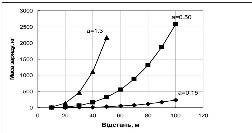
Рис.4. Графік визначення сейсмобезпеччих параметрів вибухових робіт для укосу кар'єра, що складений різними типами порід
