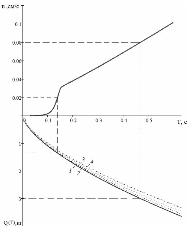
Рис. 3. Номограмма определения сейсмобезопасной массы сферического заряда при проведении взрывных работ для суглинков для различных глубин заложения заряда: 1-  $h=7,5$  м, 2 -  $h=9$  м, 3 –  $h =11,2$  м, 4 -  $h=15$  м
