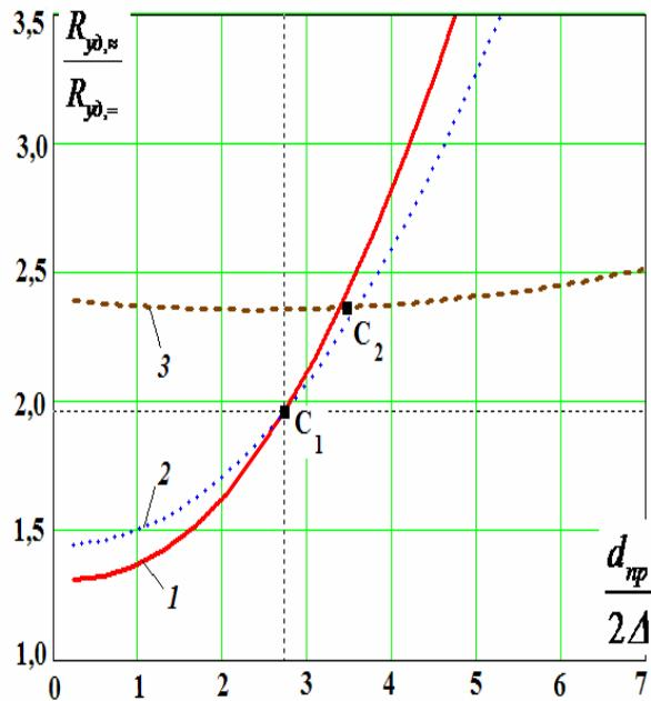
Рис. 2. Кривые зависимости прироста активного сопротивления многопроволочного провода трубчатого сечения в результате влияния поверхностного эффекта и эффекта близости от соотношения диаметра проволочки и глубины проникновения электромагнитной волны при частотах: 4 кГц (1), 5 кГц (2), 10 кГц (3)
