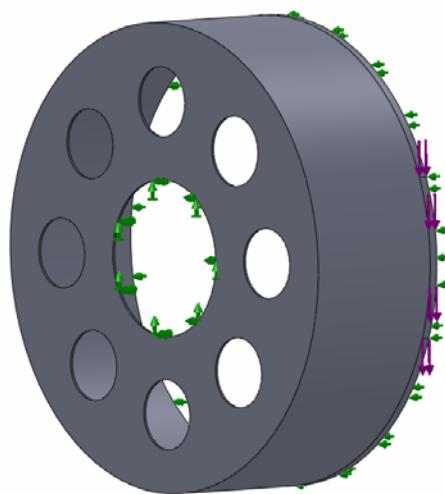
Рис.6. Твердотельная модель и расчетная схема модели силового взаимодействия каната с барабаном
