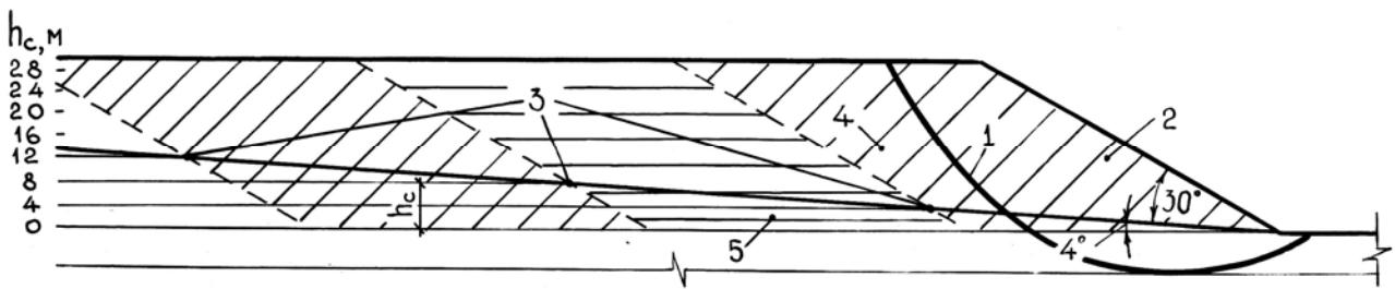
Рис. 2. Схема зрушення укосу уступу для глинистих порід: 1 - лінія ковзання; 2 - укос уступу; 3 - крапки контакту шарів на укосі по ходу посування фронту робіт; 4 - глини піщані (верхній шар); 5 - монтморилонитові глини (нижній шар)
