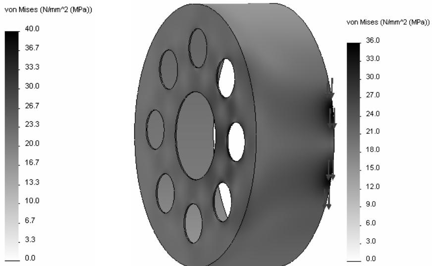
Рис.11. Эквивалентные напряжения обечайки при контактной модели взаимодействия
