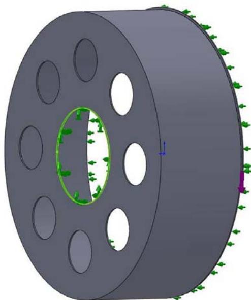
Рис.2. Твердотельная модель и расчетная схема контактной модели взаимодействия
