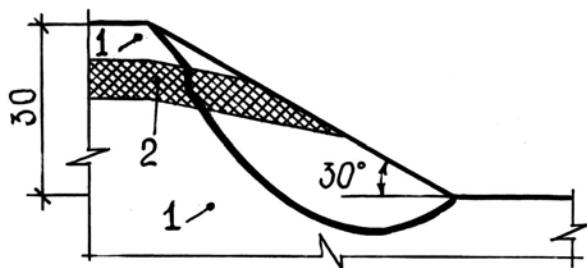
Рис. 1. Схема укосу й можливої лінії ковзання для діатомітів (середній шар) і глин опоковидних при розробці уступів висотою 30 м: 1 - глина опоковидна; 2 - діатоміти
