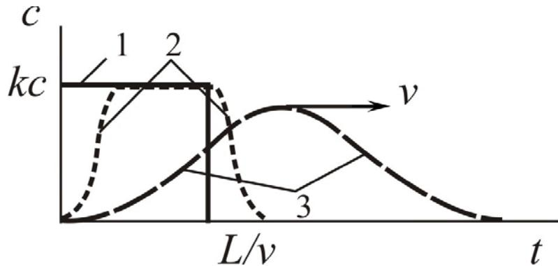
Рис. 1. Зміна концентрації газу в потоці носія на виході з пористого середовища: 1 – ідеалізований імпульс концентрації при відсутності перемішування; 2 – при обліку взаємодії (змішування) газу і фільтраційного повітря на їхніх границях; 3 – при додатковому урахуванні процесів сорбції-десорбції газу в середовищі підірваної гірської маси
