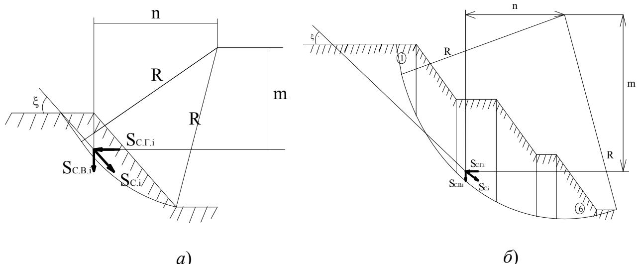
Рис.2. Схема дії сейсмічної сили: а) на уступ кар'єру; б) на борт кар'єру
