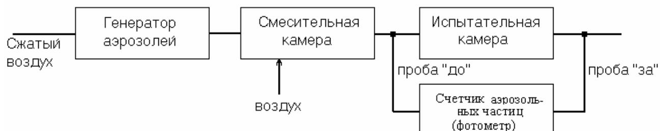
Рис. 1. Структурная схема установки для испытаний по тест-аэрозолям
