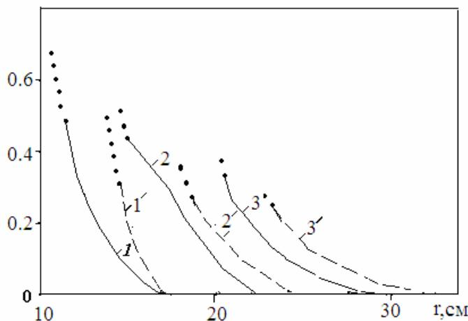
Рис. 4. Залежність радіальних напружень ґрунту від відстані при вибуху заряду амоніту № 6ЖВ при різних діаметрах частинок щебеню: 1, 1' –  $R=20 \text{ мм}$ , 2, 2' –  $R=40 \text{ мм}$ , 3, 3' –  $R=70 \text{ мм}$ . Суцільні лінії відповідають ґрунту з  $\alpha_1 = 0,1$ ; штрихові –  $\alpha_1 = 0,3$ ; чорні точки – частинкам щебеню.
