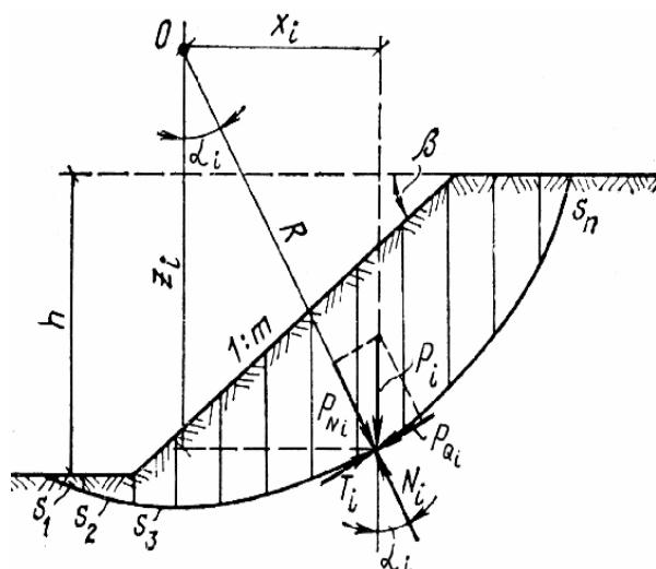
Рис.1. Схема рівнодіючих сил на  $i$ -тий відсік
