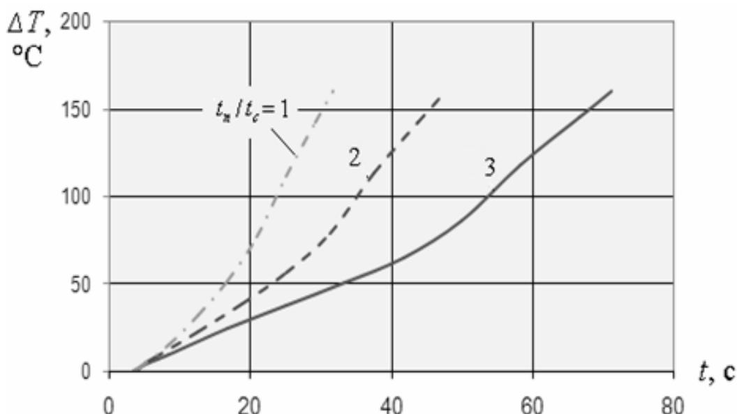
Рис. 3. Залежність  $\Delta T(t)$  при імпульсному струмі індуктора
