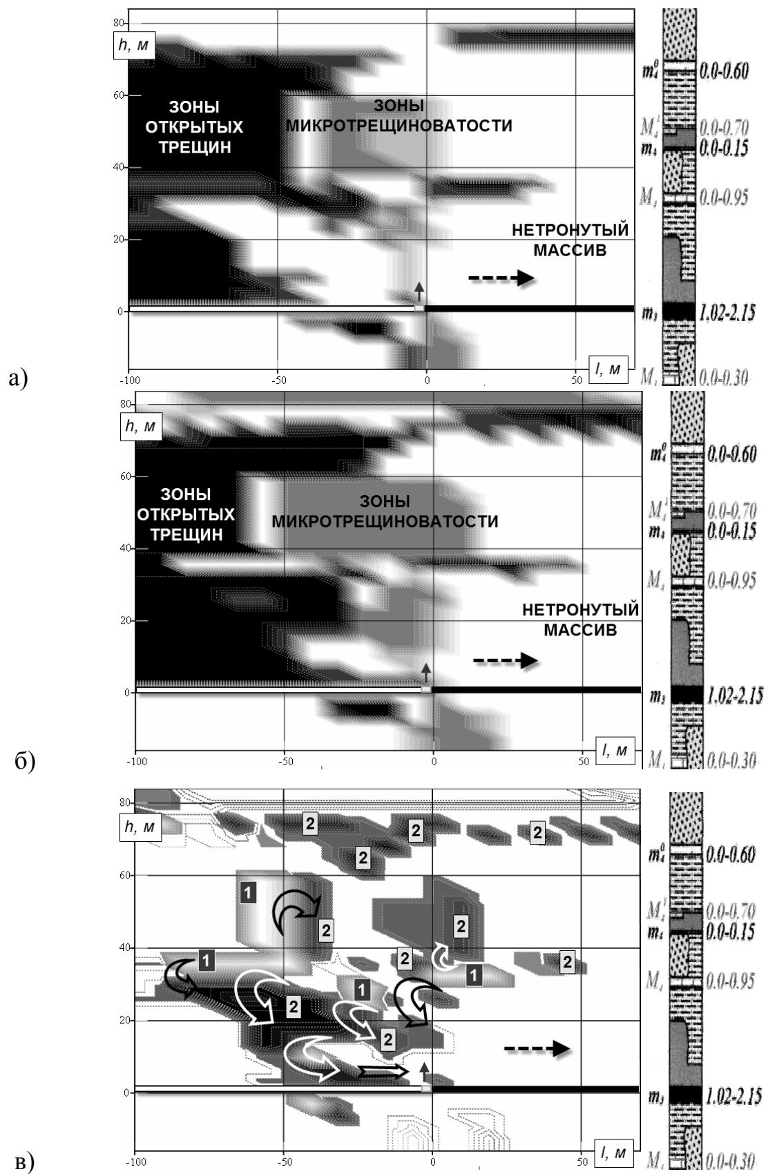
□ – упругие зоны; ■ – зоны микротрещин; ■ – зоны открытых трещин
