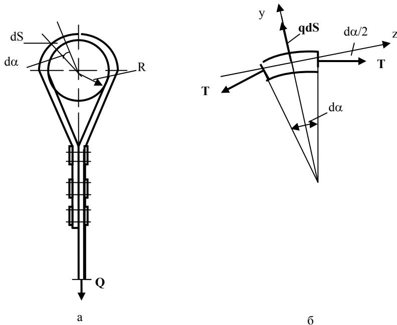
Рис. 2. Схема крепления плоского резинотросового уравновешивающего каната на прицепном барабане: а- схема крепления; б- расчетная схема сил, действующих на бесконечно малый элемент РТК
