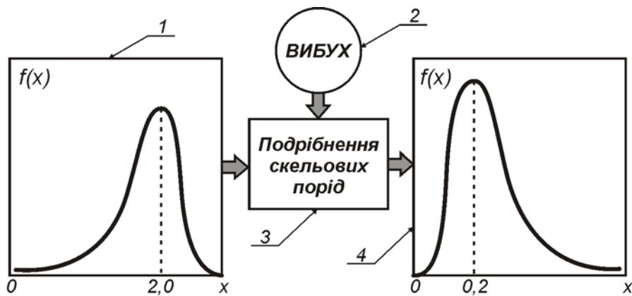
Рис. 1. Схематичне представлення переходного процесу подрібнення скельових гірничих порід вибухом,
