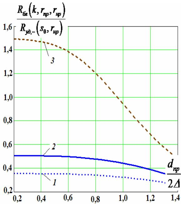
Рис. 1. Кривые зависимости прироста активного сопротивления многопроволочного провода трубчатого сечения от соотношения диаметра проволочки и глубины проникновения электромагнитной волны при частотах 4 кГц (1), 5 кГц (2), 10 кГц (3)
