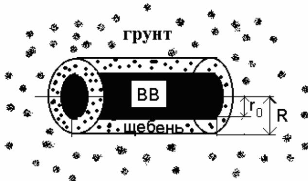
Рис. 1. Циліндричний заряд хімічної вибухової речовини (ВР), поміщеного в порожнину, заповнену щебенем, розташовану в ґрутовому масиві
