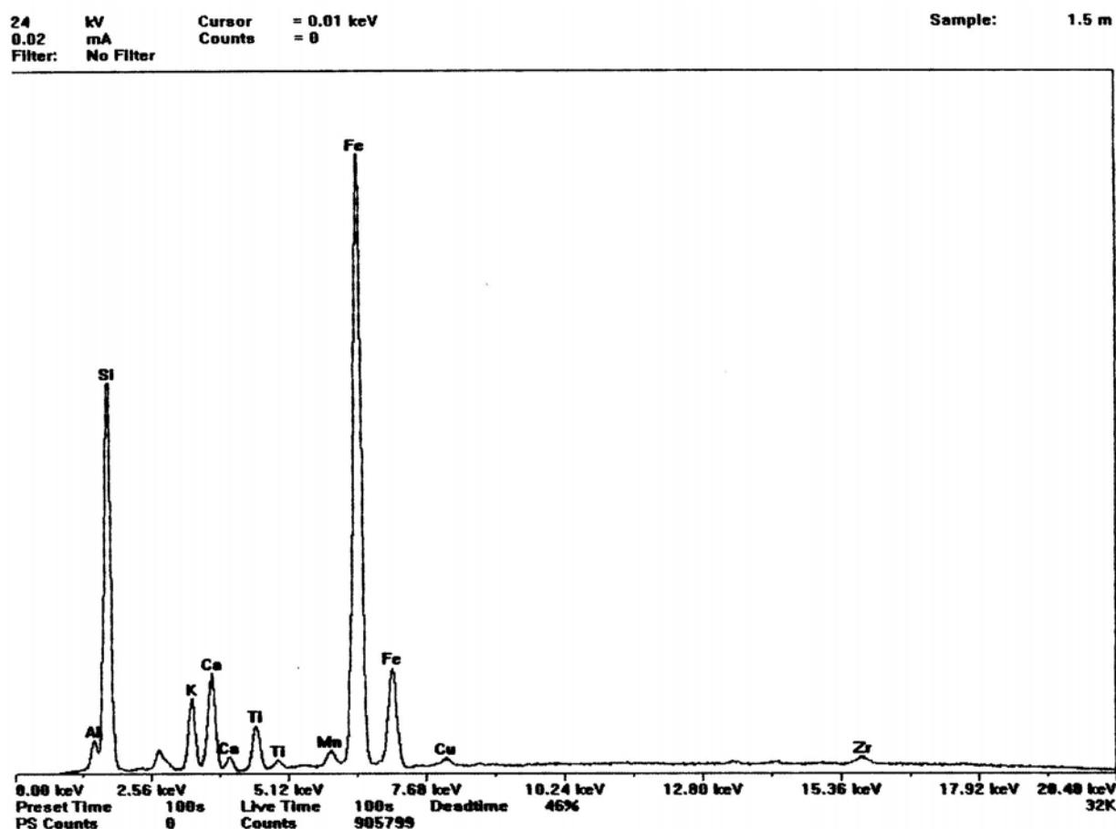
Рис. 3. Спектр химических элементов установленных в пробе чернозема на глубине 1,5 м
