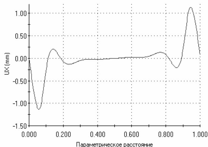
Рис.7. Радиальное перемещение кромки обечайки при модели силового взаимодействия с дугой  $60^\circ$
