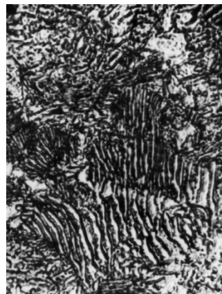
Рис.3. Сталь 55XFА. А - горячекатаная, Б - обработка однослойным зарядом, В - обработка двухслойным зарядом. Увеличение -1000
