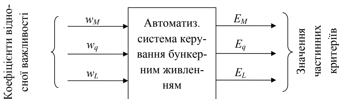
Рис. 1. Узагальнена схема керування бункерним живленням
