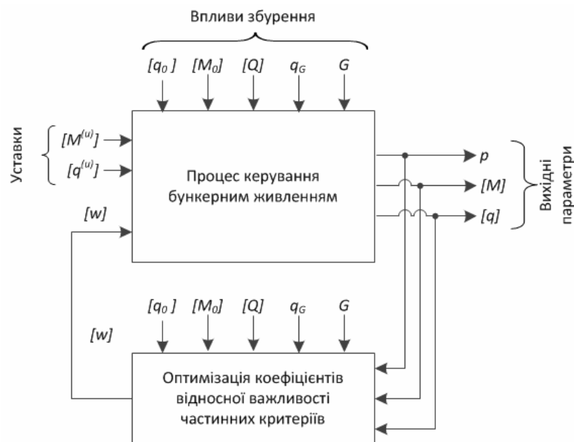
Рис. 3. Узагальнена схема системи адаптивного керування процесом бункерного живлення
