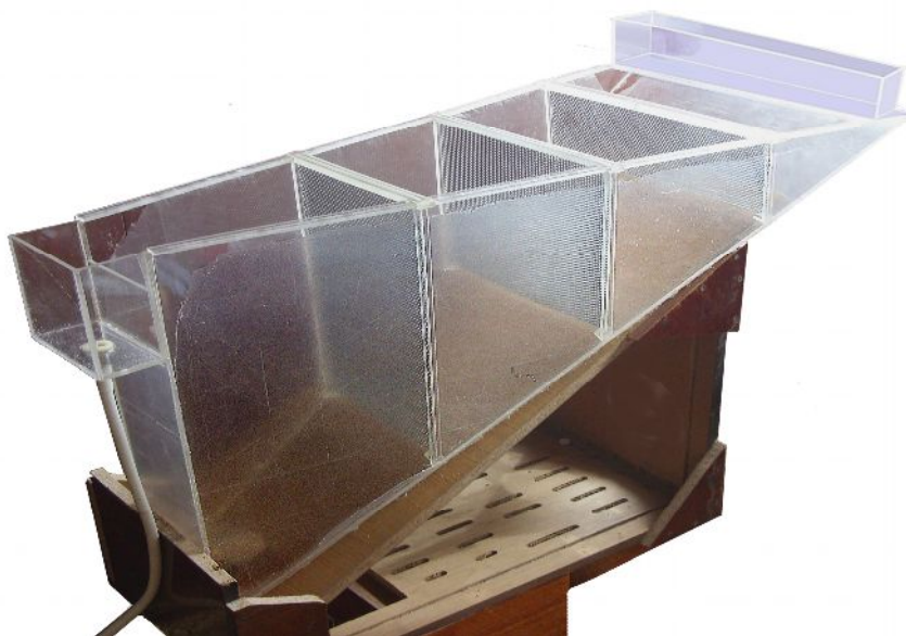
Рис. 1. Действующий макет усовершенствованного горизонтального отстойника (масштаб 1:20)
