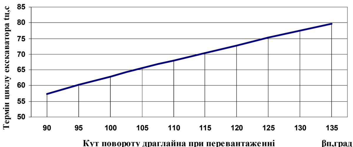
Рис. 3. Графік залежності тривалості робочого циклу драглайну ЕШ-20/90 від кута повороту при навантаженні гірничої маси до бункера-перевантажувача
