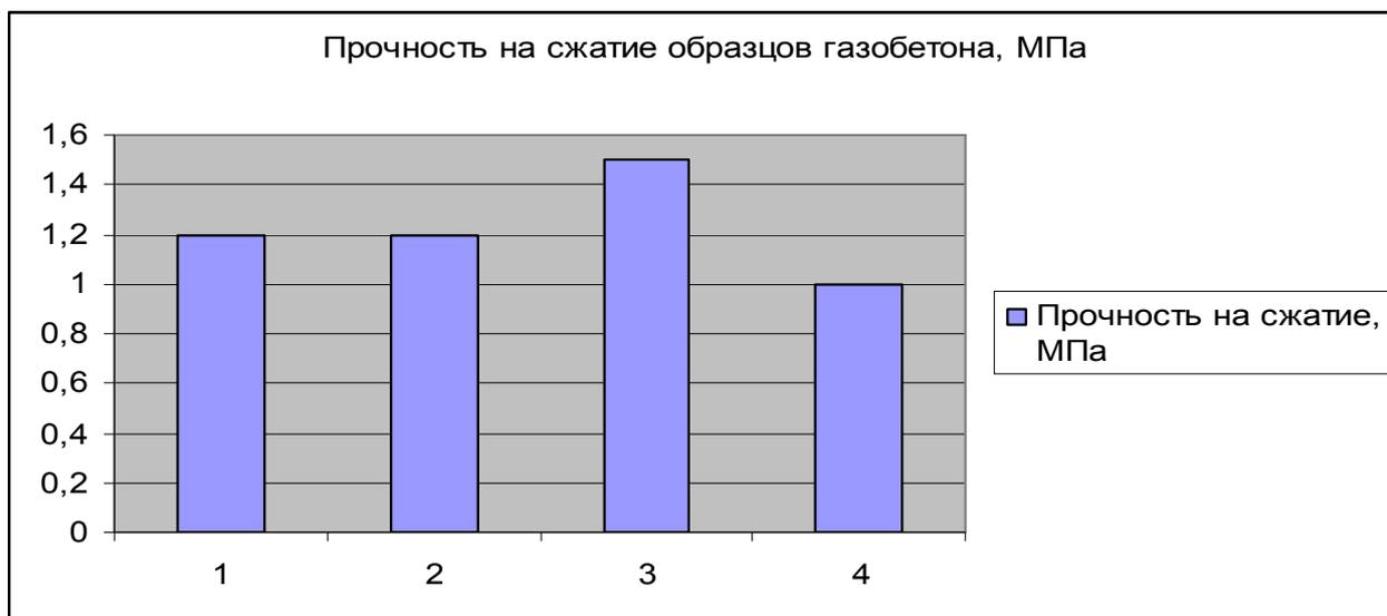
Рис. 1. Прочность на сжатие образцов газобетона. Где 1-добавка стеклобоя, 2- добавка шлака, 3 – добавка стеклобоя+шлака, 4-норматив.
