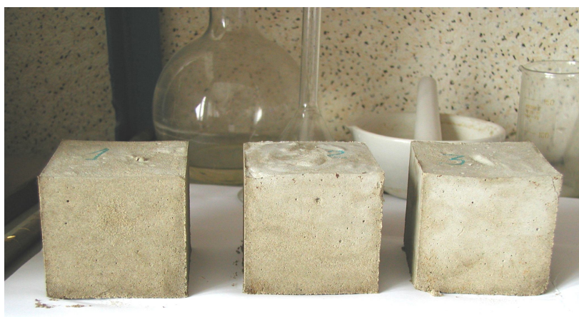
Рис. 2. Опытные образцы-кубы после освобождения из металлической формы
