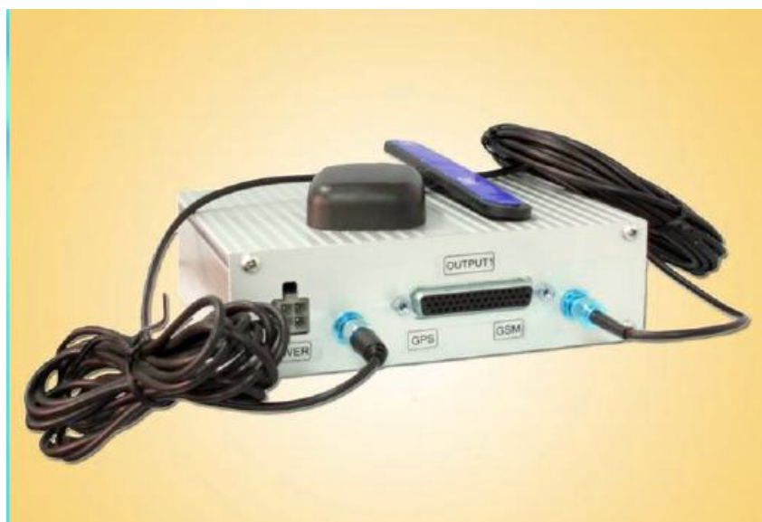
Рис. 6. Общий вид бортового контроллера автосамосвала
