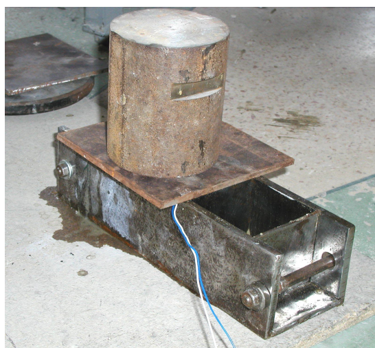
Рис. 1. Приложение динамической нагрузки на образец-куб: а – подготовка образца; б – проведение эксперимента
