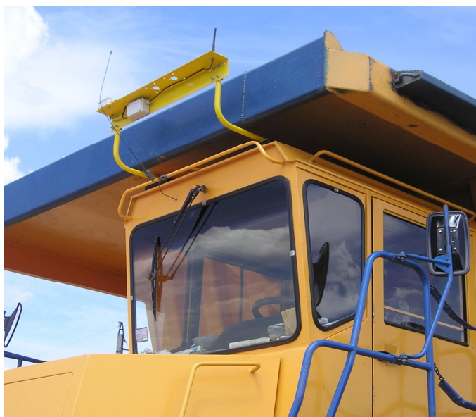
Рис. 4. Общий вид навигационного оборудования автосамосвала БелАЗ-7548
