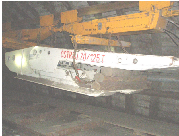
Рис. 2. Транспортування секцій механізованого кріплення в умовах шахти «Степова» ПАТ «ДТЕК Павлоградвугілля»
