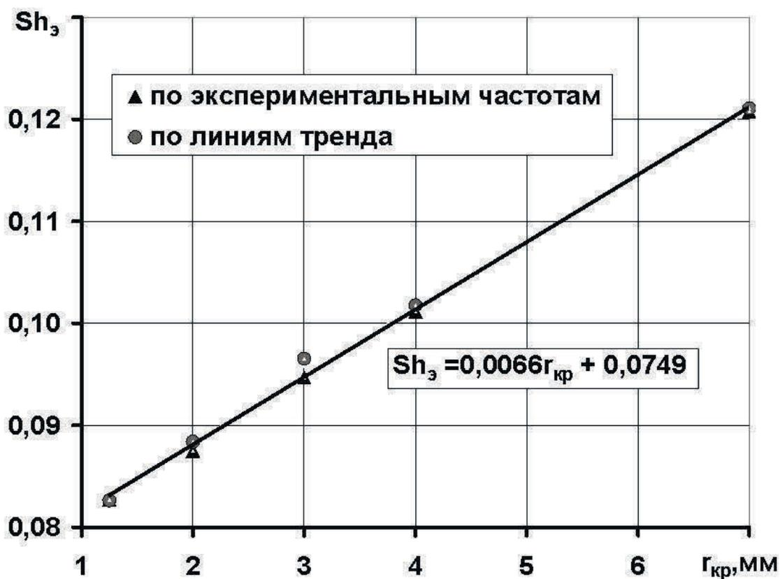
Рис.2. Зависимости числа Струхалия Sh<sub>э</sub> от радиуса критического сечения генератора r<sub>кр</sub>
