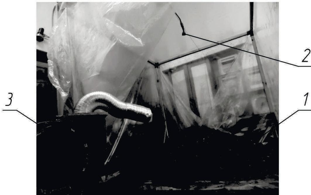
Рис. 4. Схема экспериментальной установки: 1 – угольный штабель, 2 – форсунка, 3 – воздуховодка
