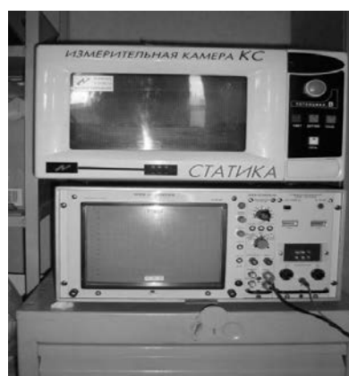
Рис. 2. Схема установки з вимірювання електростатичного потенціалу на поверхні фільтрувального матеріалу
