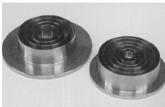
Рис. 4. Матриці для формування гофрованих фільтрів з конусних заготовок для респірації
