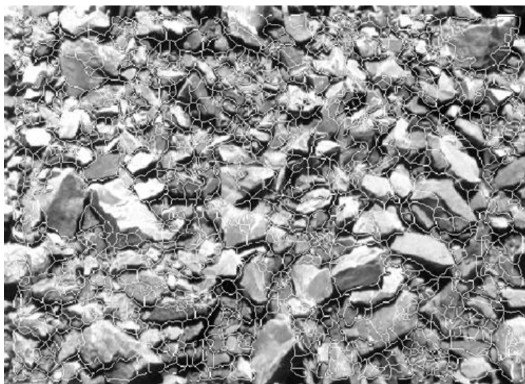
Рис. 3. Пример преобразовать снимка горной массы в «сети фрагментов (отдельностей)»
