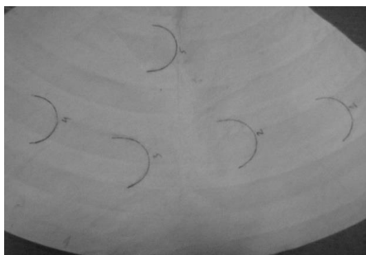
Рис. 3. Точки розташування електроду для заміру електростатичного заряду на поверхні фільтрувального матеріалу
