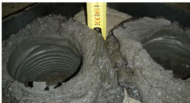
Рис. 6. Внешний вид расплава (тампонажного камня) полученного при частоте вращения  $500 \text{ мин}^{-1}$  и осевой нагрузке равной  $700 \text{ даН}$ , для ТПКМ с соотношением компонентов 1:3
