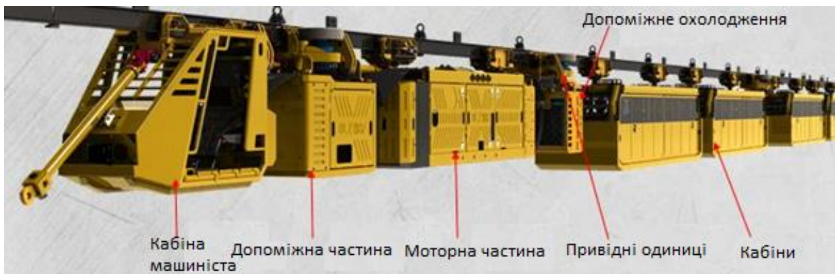
Рис. 3. Підвісний дизельний локомотив типу DLZ110F-5 фірми «Ferrit»
