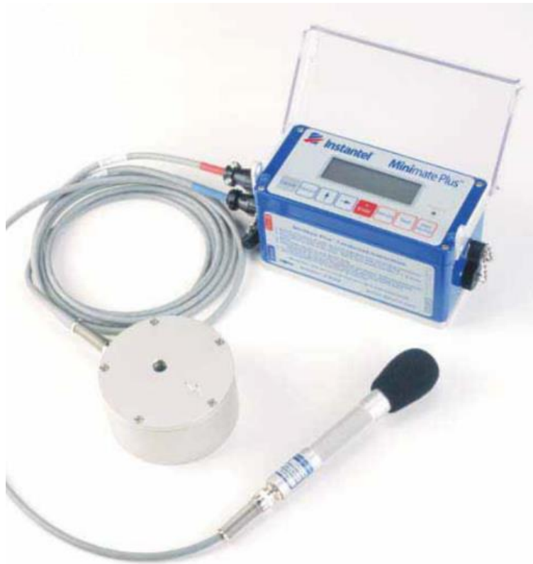
Рис. 2. Загальний вигляд сейсмографу MiniMate Plus
