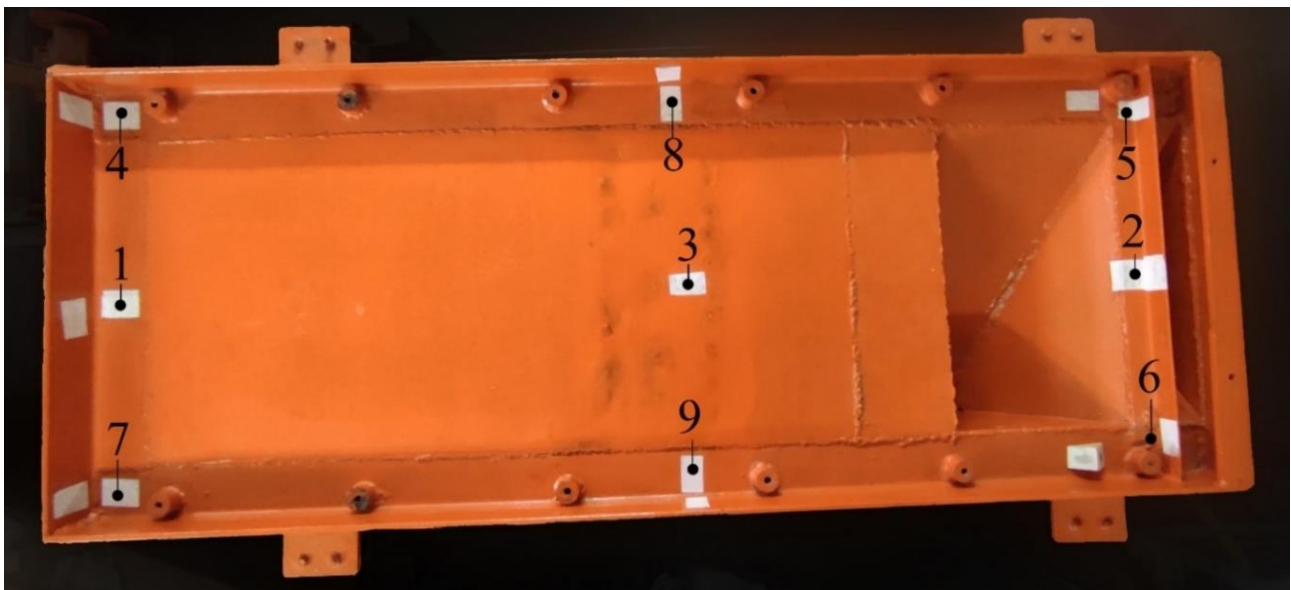
Рис. 8. Місця кріплення датчиків на коробі грохоту
