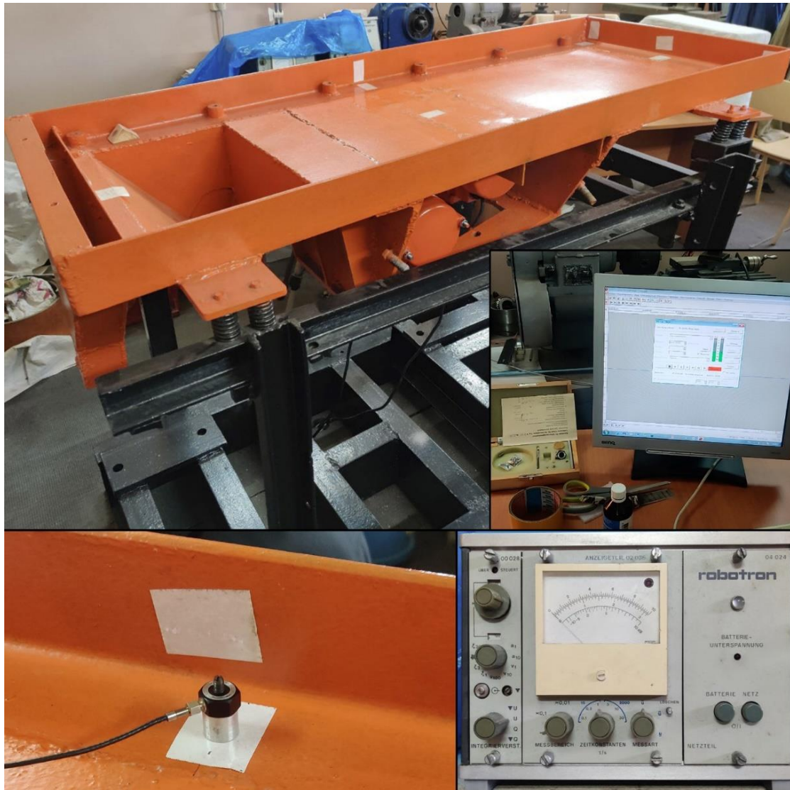
Рис. 5. Основні компоненти лабораторного стану для дослідження грохотів
