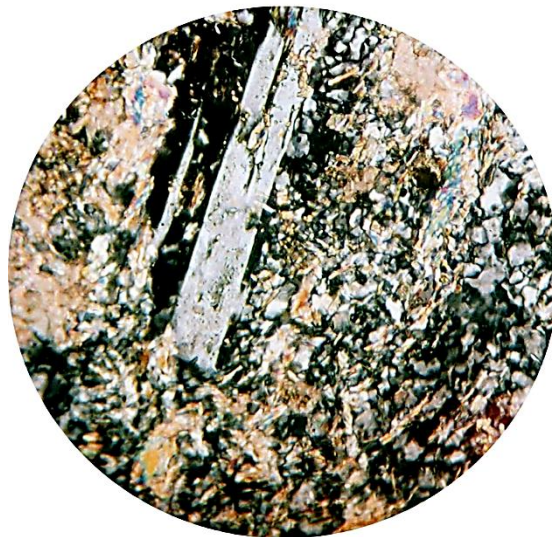
Рис. 4. Ліственит-березит по ріоліту з реліктовою порфіровою структурою (вкрапленники плагіоклазу) Збільшення \times 120 , ніколі+
