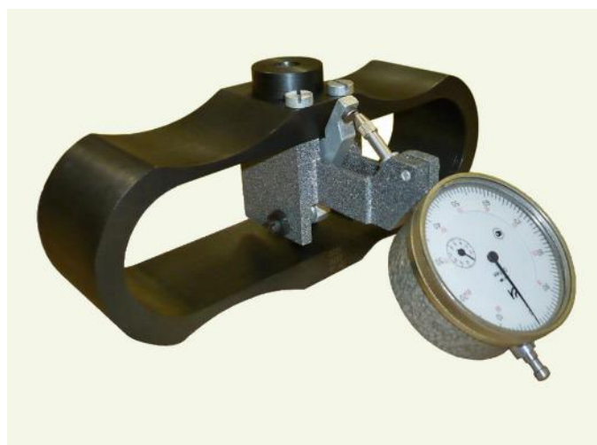
Рис. 2. Загальний вигляд динамометр механічний на стиск ДОСМЗ-5 (межа вимірів 50kN (5000 кг))
