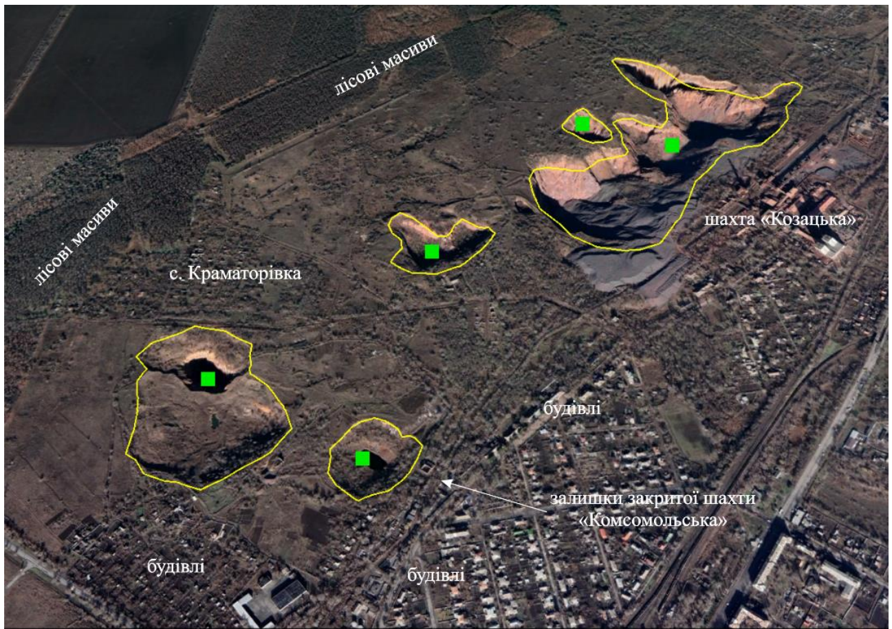
Рис. 2. Група досліджуваних провалів діючої шахти «Козацька» та закритої шахти «Комсомольська»
