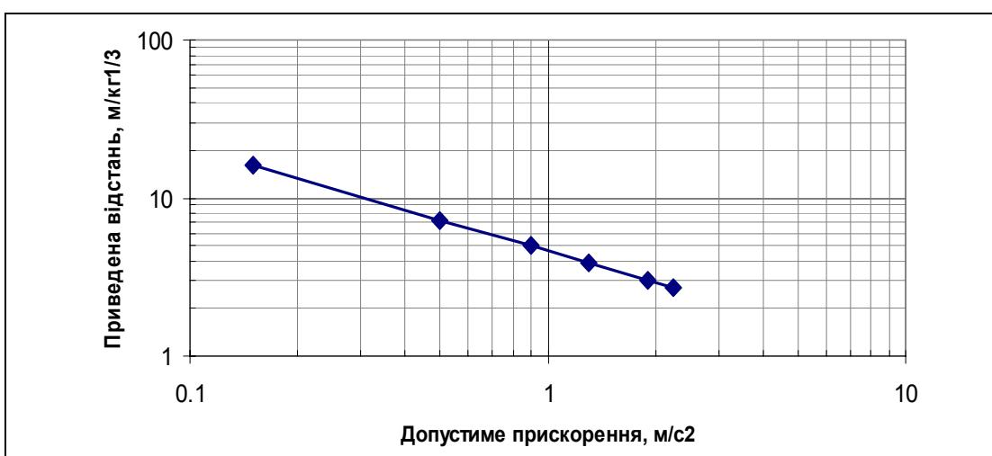
Рис.3. Залежність допустимих значень інтенсивності впливу СВХ на укоси (в одиницях прискорення) від приведеної відстані до допустимої маси групи зарядів, що одночасно підриваються ( $\text{м}/\text{кг}^{1/3}$ )
