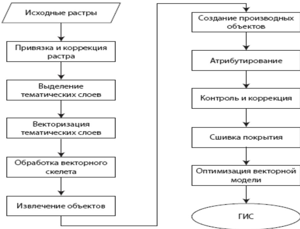
Рис. 3. Технологическая цепочка процесса векторизации космического снимка
