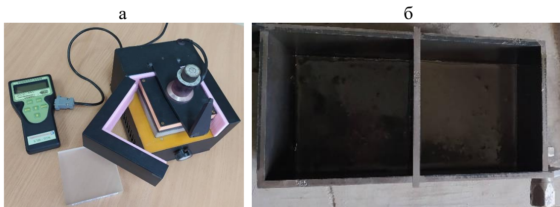
Рис. 1. Прилад для вимірювання теплопровідності IPT-MG4 «100» (а) з фурнітурою для формування зразків теплоізоляційних матеріалів (б)
