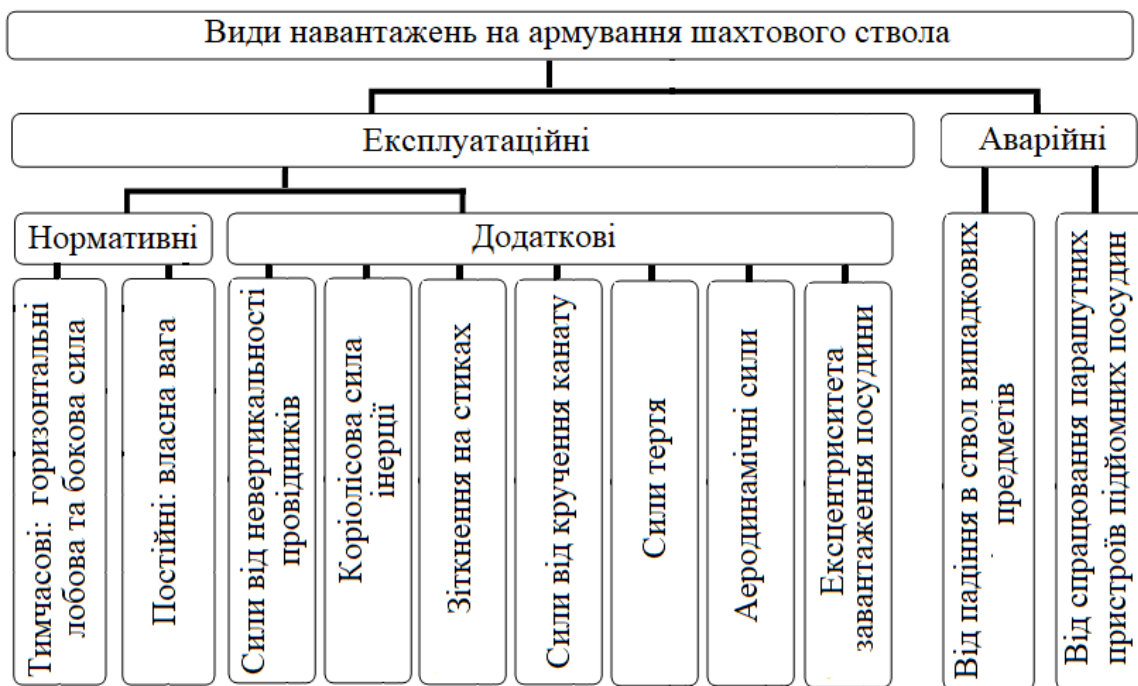
Рис. 1. Групи навантажень на армування шахтового ствола за принципом дії
