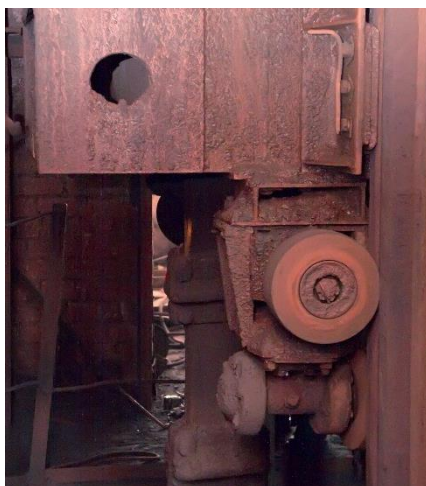
Рис. 2. Негативна дія корозії на елементи шахтового обладнання
