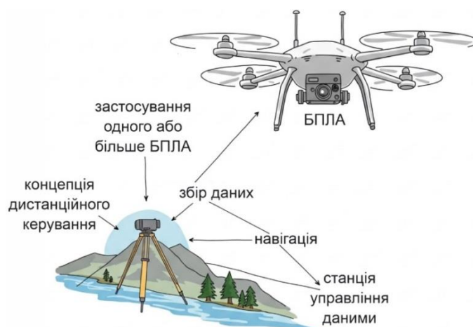
Рис. 3. Приклад застосування БПЛА при аерофотозйомці для отримання високоякісних зображень великих територій з великою деталізацією
