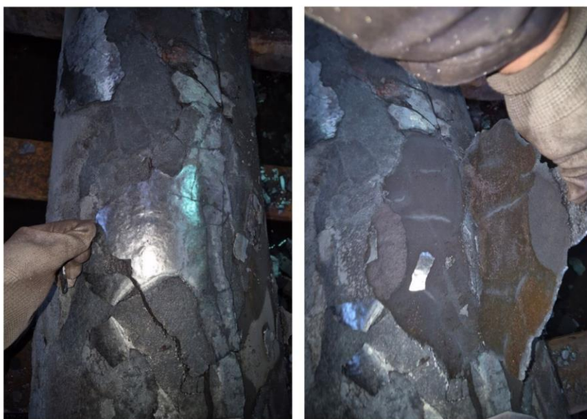
Рис. 2. Внутрішня (пориста) та зовнішня частина шару окалини
