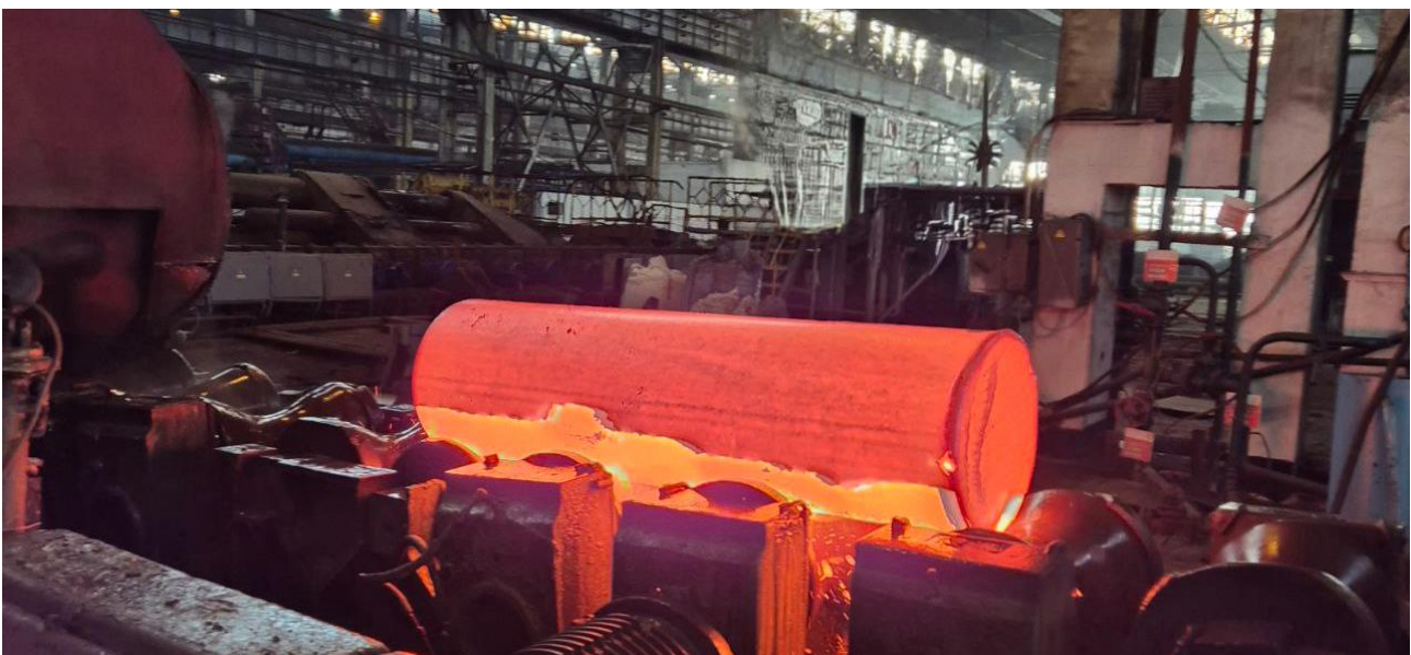
Рис. 1. Процес утворення окалини під час гарячої прокатки сталі
