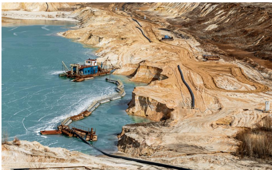
Рис. 1. Загальний вигляд комплексу гідромеханізації в кар'єрі Мотронівського ГЗК
