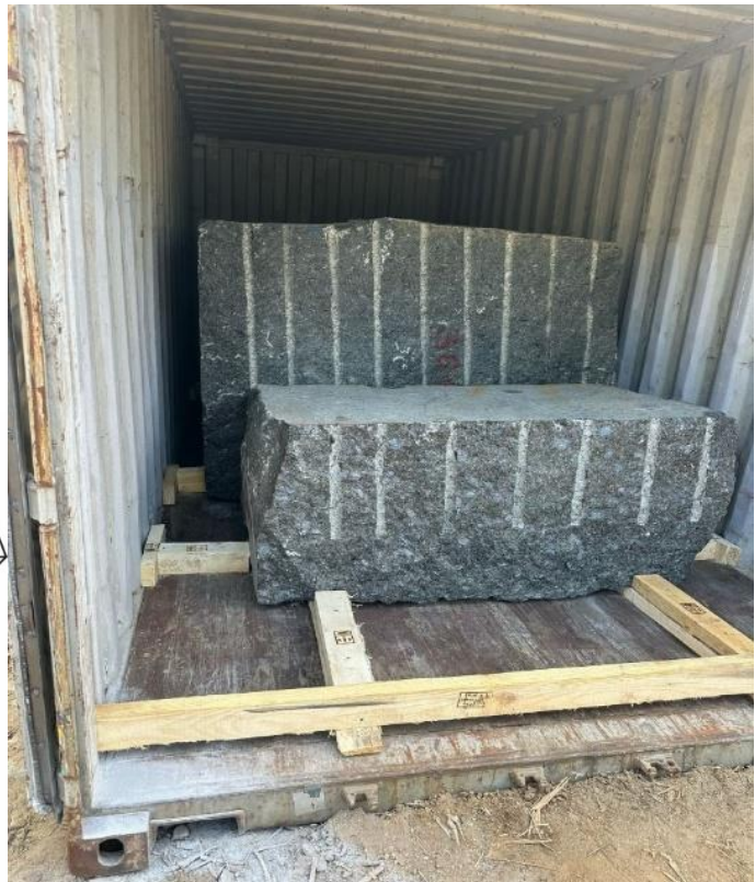
Рис. 3. Схема розміщення повздовжніх брусів на підлозі контейнера конструкція «Квадратна рама»: 1 – дерев'яний брус або дошка вздовж стінки контейнера; 2 – поперечний упорний дерев'яний брус в дверному прольоті; 3, 5 – дерев'яний брус на якому стоїть блок каменю; 4 – торцевий розпірний дерев'яний брус; 4 – боковий розпірний дерев'яний брус
