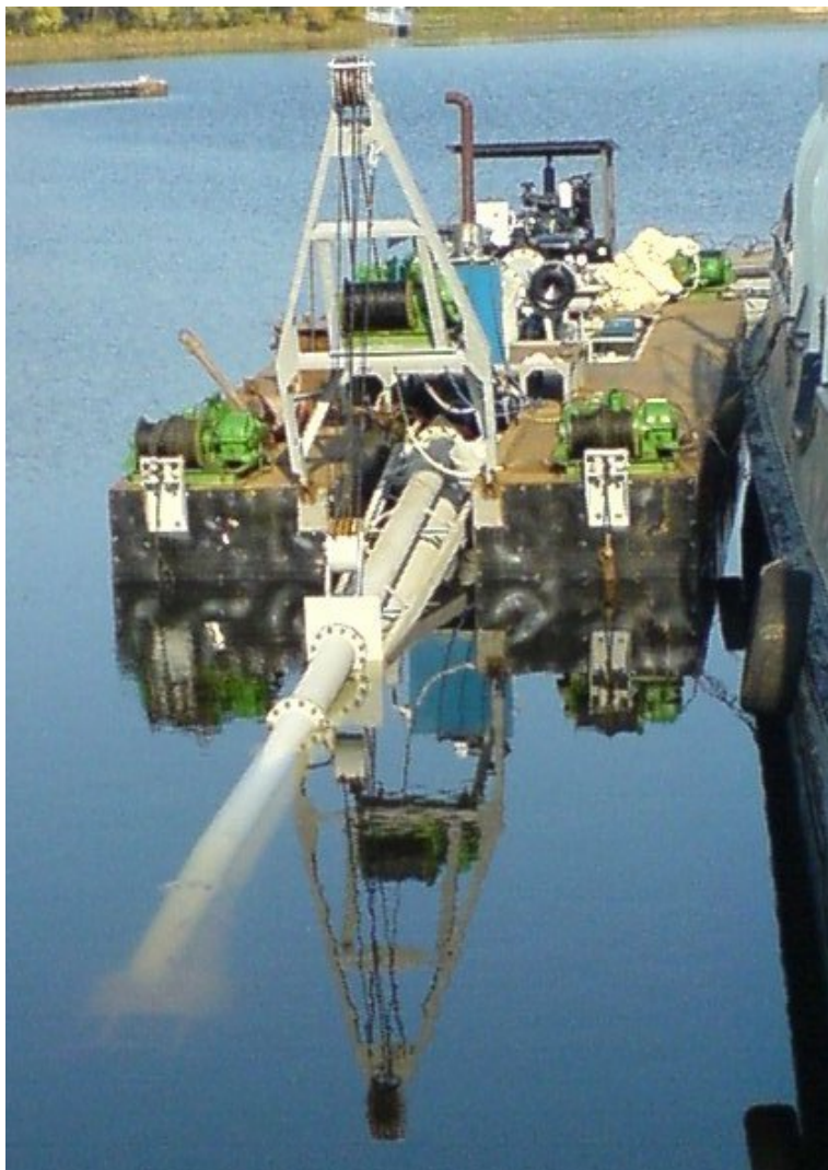
Рис. 2. Прототип ежекторного земснаряда ЗНС 630-90
