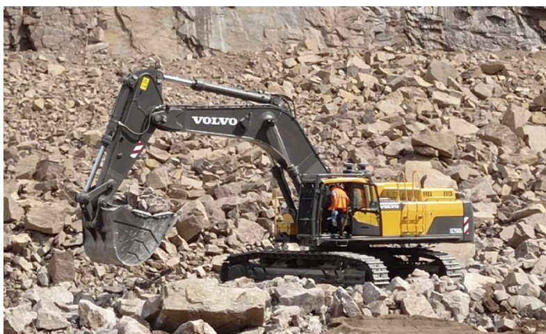
Рис. 5. Робота гідравлічного екскаватора (Volvo EC750DL) у скельному вибої гранітного кар'єру
