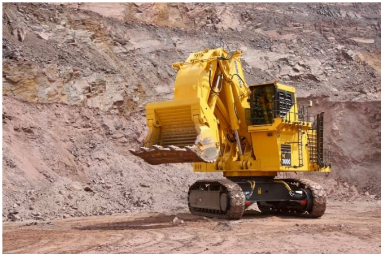
Рис. 4. Гідравлічний екскаватор класу надвисокої одиничної потужності (Komatsu PC3000) в умовах залізорудного кар'єру
